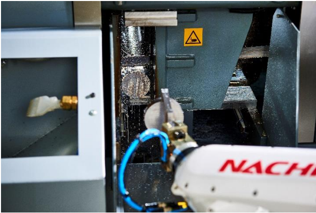
Entnahme der gesägten Teile
