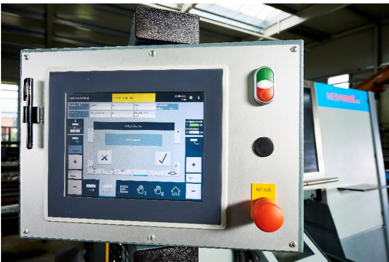
Zentrale Bedienung von Säge UND Roboter
